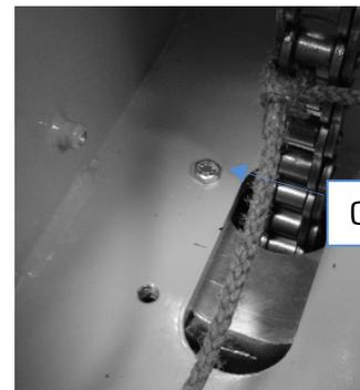
D- À l'aide d'une pince à bec déposer l'attache rapide
