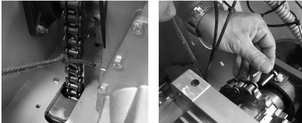
F-Laisser descendre l'ensemble de compensation au fond du fût de la barrière et sortir le ressort avec la cloche
