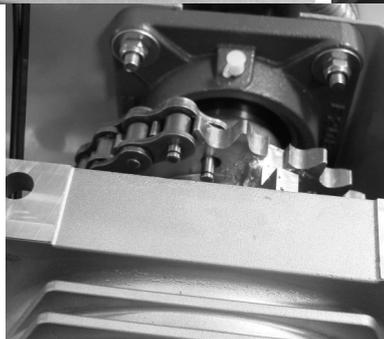
E - Avant d'ôter complètement l'attache rapide, à l'aide d'une corde attacher la chaîne pour faire descendre par la suite l'ensemble du système de compensation.
