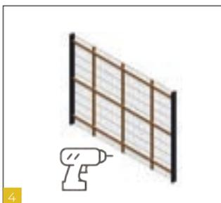
4 - Positionnez une latte intermédiaire au centre du panneau puis vissez la latte directement au renfort. Vissez ensuite les lattes déjà positionnées aux renforts. Pensez à ajuster la hauteur des lattes.
